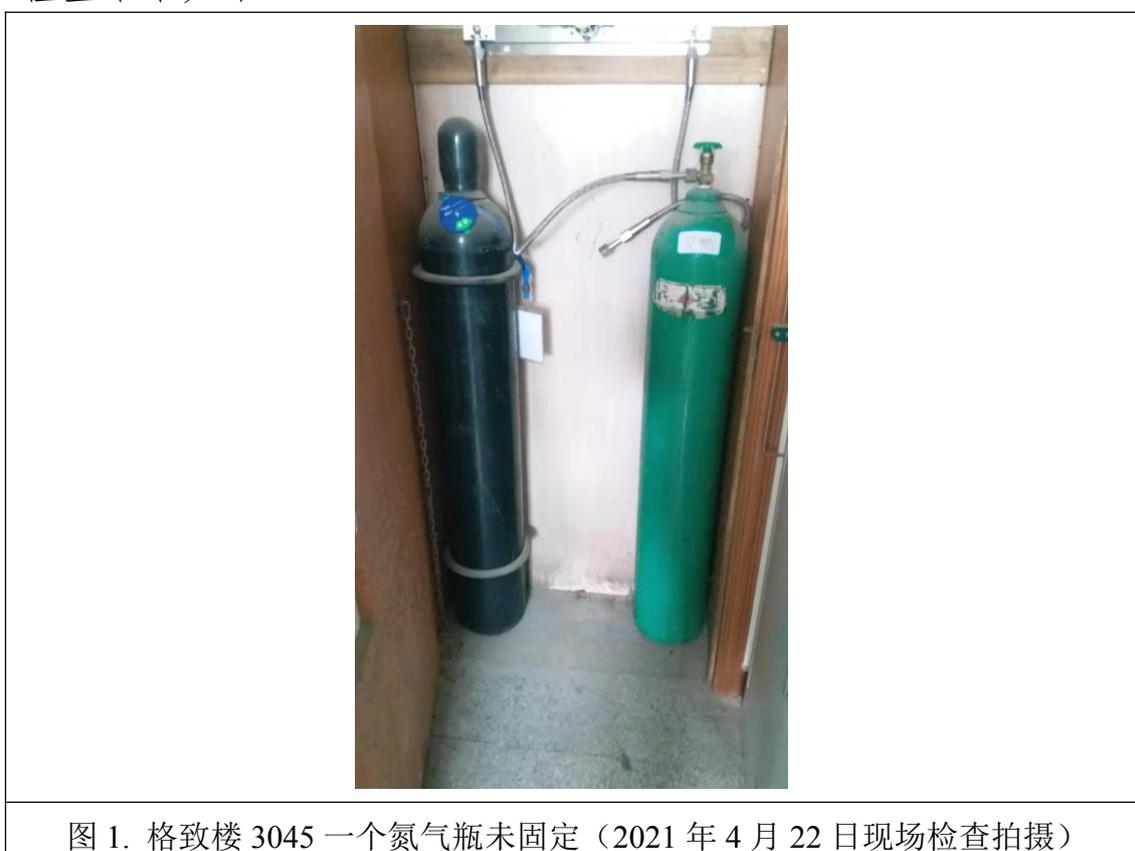
图 1. 格致楼 3045 一个氮气瓶未固定（2021 年 4 月 22 日现场检查拍摄）
