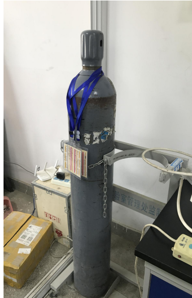
图 2. 格致楼 1037-1 两个气瓶无防震胶圈。
