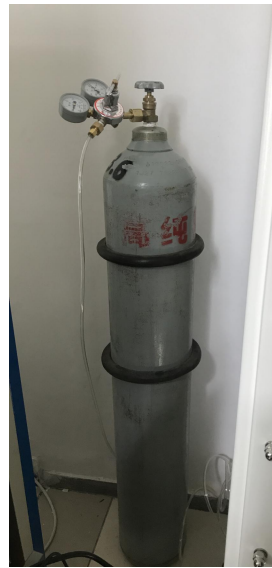
图 4. 格致楼 1049 一个气瓶未固定。
