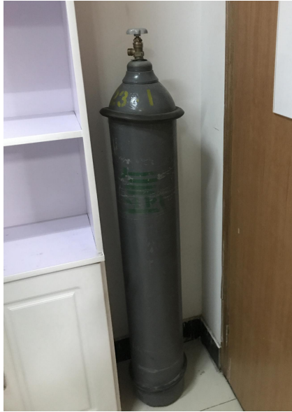
图 1. 格致楼 1037-1 一个氩气瓶放在共用通道且没固定。
