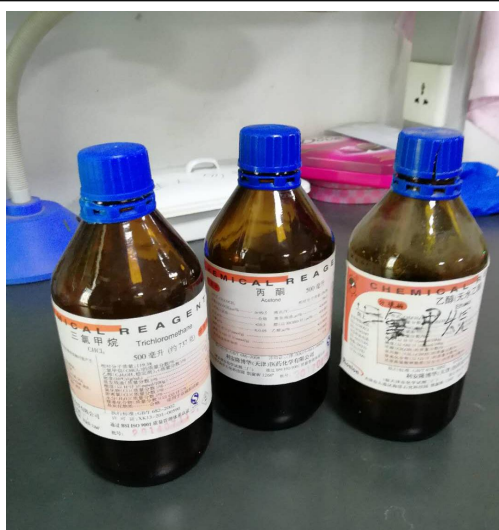
图 1. 格致楼 1010 实验室，三氯甲烷、丙酮（分别属于第二、三类易制毒品），应按要求分类存放、专人保管，本次检查发现该室 2 瓶三氯甲烷、1 瓶丙酮使用后未及时专柜存放问题。
